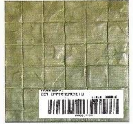
MOLDE: Baldosa 10x10 COLOR: Acero DESMOLDANTE: Verde
